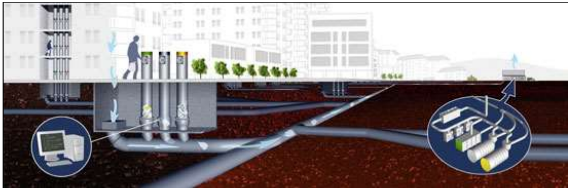
Figur 5-10 Stasjonært avfallssug. (Kilde: www.envac.no )
